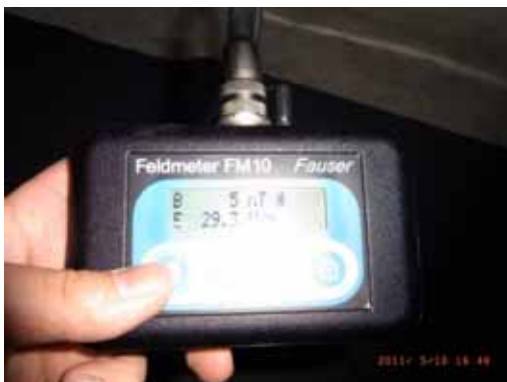
シールド施工済 アース非接続時の電界強度 29.3V/m
